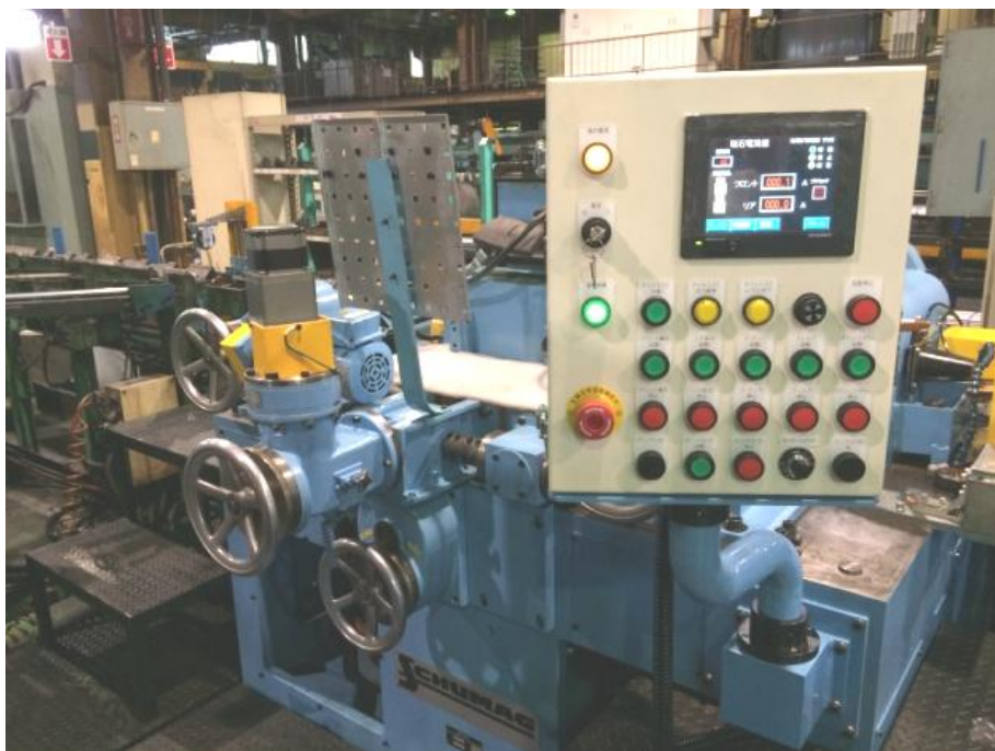
OH後の設備と改良した操作盤
